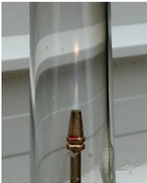
FIGURE 12 – Flamme alignée avec la graduation correspondant à  $\frac{L}{4}$
